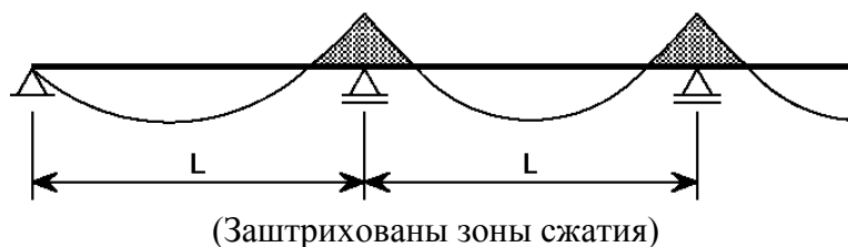
Рисунок 10.4 — Изменение сжимающих напряжений в свободной полке при действии гравитационной нагрузки
