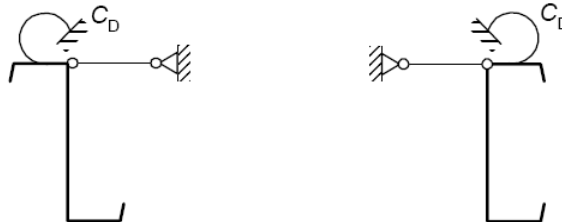
Рисунок 10.1, лист 1 — Моделирование прогонов, раскрепленных настилом из плоскости от кручения
