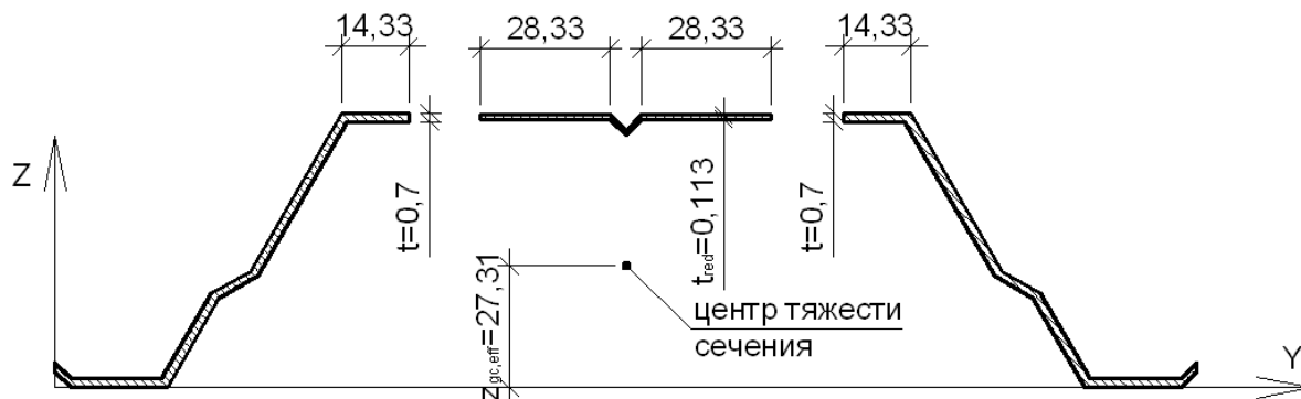
Рисунок 43 — Эффективное сечение трапециевидного профилированного профиля в позиции «позитив».
